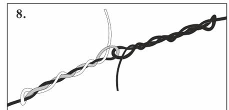
Данный способ соединения не требует дополнительных крепежных приспособлений. Сохраняет покрытие троса от повреждения.
